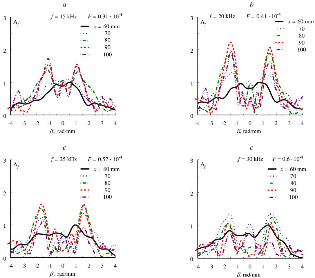
Figure 6: Wave spectra at  $f=15$  (a), 20 (b), 25 (c) and 30 (d) kHz.
