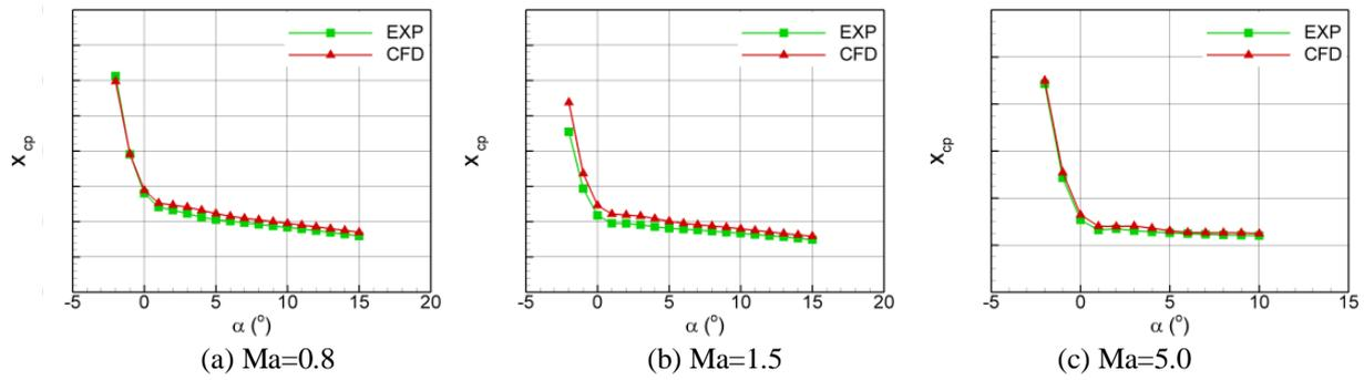
Fig. 5: longitudinal pressure center
