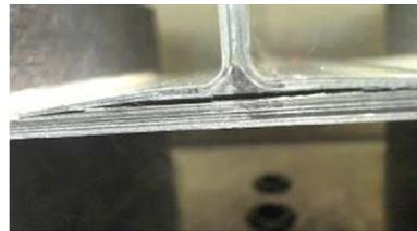
Fig: Stringer Foot delamination
