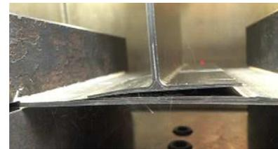
Fig: Stringer Foot delamination
