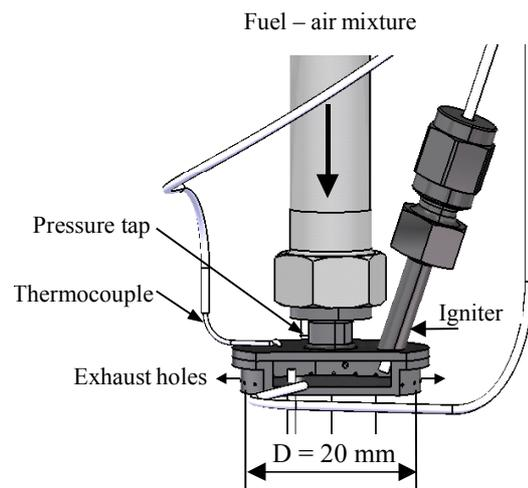
Fig. 9b : Combustion chamber
